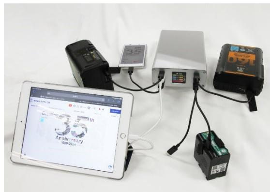
UC-PD6 は、トータルで最大 440W の 6ch 高出力同時急速 USB PD 充電器です。
