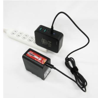
SL-F50PD および SL-F70PD は、Sony L シリーズ 7.2V タイプリチウムイオンバッテリーです。
